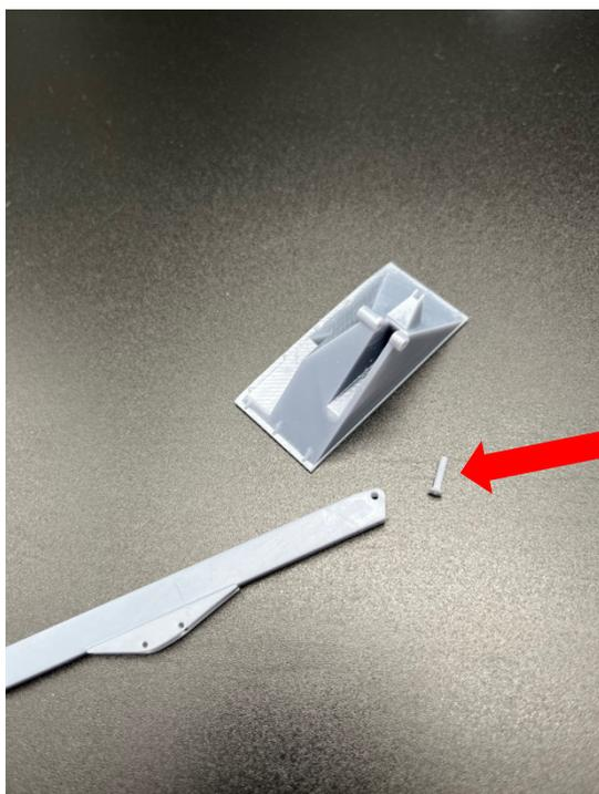
**zu 2:** Die Lagerabdeckung/Achse wird an die Bohrungen soweit angepasst, sodass diese sich sauber einfügen lässt.
