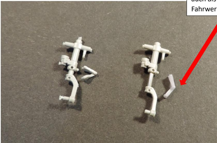
**zu 5:** Die neue Fahrwerksschere Pos.6 dient auch als „Längenangabe“ für das neue Fahrwerksbein.
