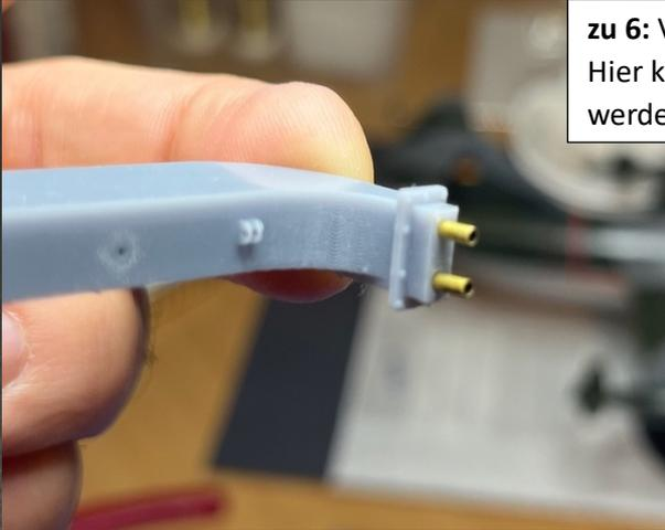
**zu 6:** Verstiftung zwischen Pos.1+2/3 mittels Messingrohr.
