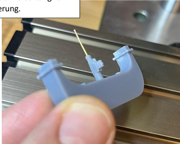
**zu 5:** Booster und Rückrollsicherung sind später eine Einheit und werden auf die Verstiftung im Ausleger Pos.3 aufgeschoben.
